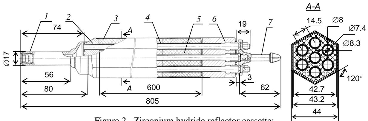
Figure 2. Zirconium hydride reflector cassette:
